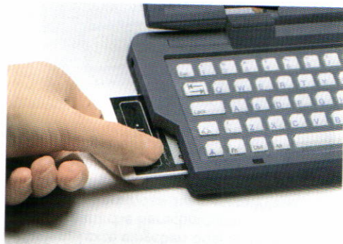
Memory Cards als Massenspeicher mit 32, 64 und 128 KB Kapazität.
